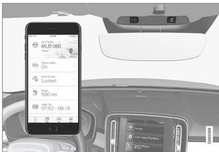
Il est possible par exemple de verrouiller ou de déverrouiller le véhicule ou de vérifier son niveau de carburant directement à partir d'un téléphone ou d'un autre appareil connecté via l'application Volvo On Call. En cas d'accident, l'assistance d'urgence (ambulances, police etc.) peut être appelée auprès du véhicule. L'assistance routière peut être contactée pour des problèmes peu urgents, comme une crevaison.
