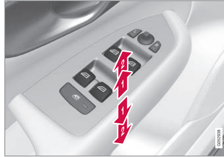
Керування вікнами з електропідійомниками.
