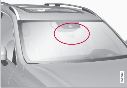
Radar ünitesi konumu
