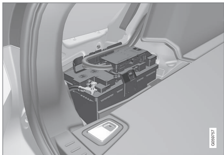
Пусковой аккумулятор находится в грузовом отсеке.
