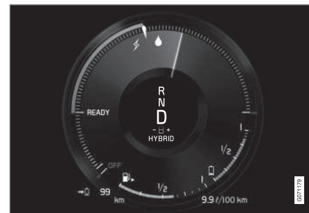
Дисплей водителя при использовании электрического двигателя и двигателя внутреннего сгорания.
