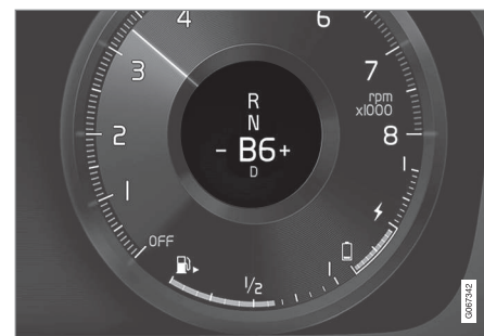
Индикатор выбранной скорости на дисплее водителя 5 .
