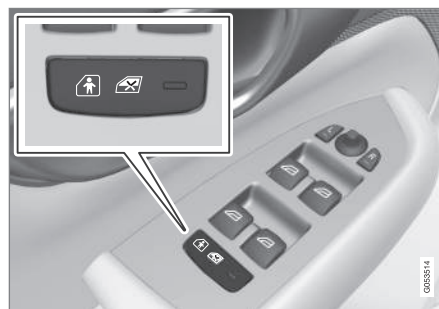
Кнопка для активирования и отключения электрической блокировки.
