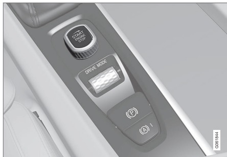
Ручка запуска в тоннельной консоли.
