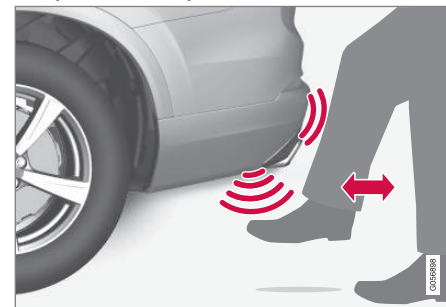
Мах ногой в пределах зоны действия датчика.
