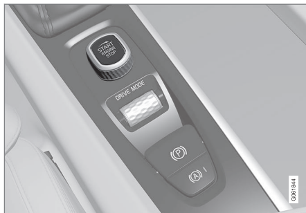
Ручка запуска в тоннельной консоли.
