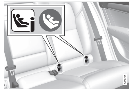
Расположение точек крепления обозначается символами 2 на обивке спинки сиденья.
