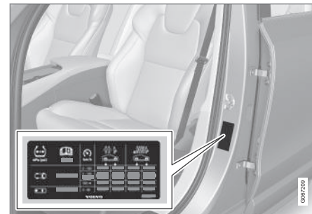
Расположение наклейки с указанием давления в шинах
