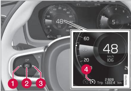
Para poder iniciar o controlo da velocidade a partir do modo de espera é necessário que a velocidade presente seja de 30 km/h (20 mph) ou superior.
