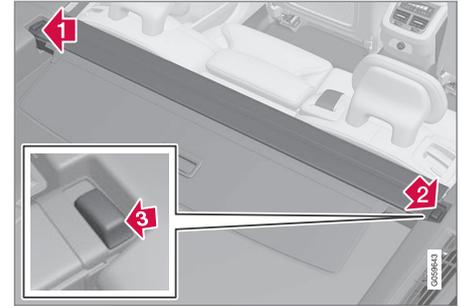
1. insira uma extremidade da cobertura da bagagem na reentrância do painel lateral no compartimento da carga.
