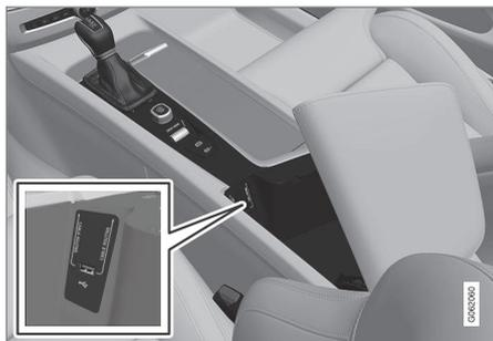
Entradas USB (tipo A) na consola de túnel. Colocar os cabos para a frente, para não ficarem entalados ao fechar a tampa.
