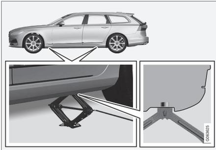
5. Coloque o macaco sobre uma superfície plana, sólida e não escorregadia sob o ponto de fixação a utilizar.
