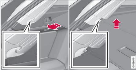
1. Segure a pega e puxe a cobertura de carga de modo a estender a mesma sobre os painéis laterais no compartimento da carga. Puxe até à posição final.
