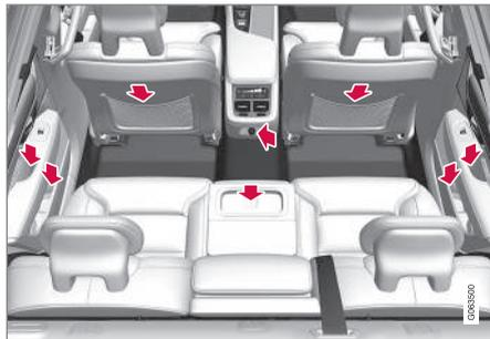
Compartimento de arrumos no painel da porta, porta-canecas\* nas costas do lugar central, bolsa de arrumação\* nas costas do banco dianteiro e tomada elétrica na consola de túnel.
