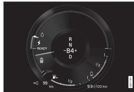
O mostrador do condutor indica carregamento na travagem com o motor elétrico.
