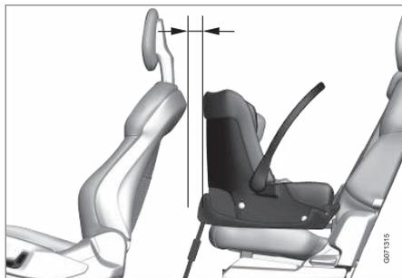
Ao montar a proteção de bebê no banco traseiro a Volvo recomenda uma distância mínima de 50 mm (2 polegadas) entre a parte mais adiantada da proteção de bebê e a parte mais recuada do banco à frente.
