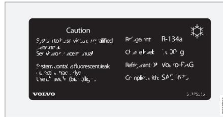
2 Autocolante sistema A/C para automóveis com refrigerante R134a.
