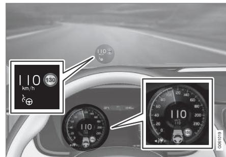
A imagem anterior mostra que o Pilot Assist está definido para manter 110 km/h (68 mph) e que não existe qualquer veículo à frente para seguir.
