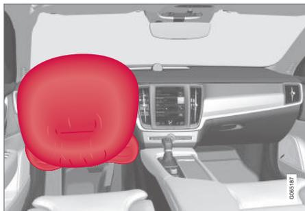
Airbag do volante e airbag do joelho<sup>1</sup> no lado do condutor no banco dianteiro.
