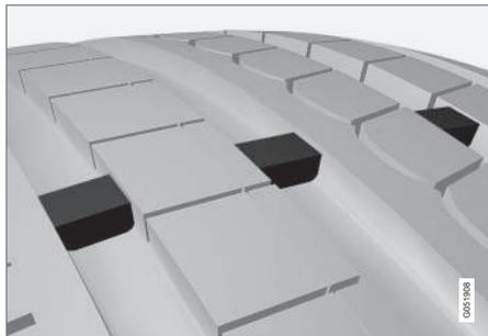
O indicador de desgaste é uma pequena protuberância que atravessa os sulcos do pneu. No lado do pneu aparecem as letras TWI (Tread Wear Indicator). Quando a profundidade de sulco estiver reduzida a 1,6 mm (1/16 tum), o rasto do pneu fica nivelado com os indicadores de desgaste. Nesta situação substitua logo que possível por pneus novos. Lembre-se que os pneus com pouca profundidade de sulco têm uma aderência muito reduzida com chuva e neve.
