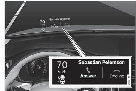
O head-up-display apresenta avisos e informações relativos à velocidade, funções do controlo da velocidade, navegação, etc. no campo de visão do condutor. Informações de trânsito e chamadas telefónicas de entrada também podem ser exibidas no head-up-display.
