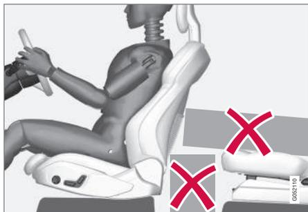
Não coloque qualquer objeto no piso atrás ou sob os bancos da frente ou no banco traseiro que possa evitar o funcionamento do WHIPS.
