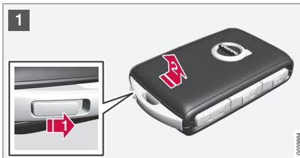
1 **1** Segure a chave com o lado da frente visível e o logótipo da Volvo virado para cima - desloque para a direita o botão que se encontra junto ao aro, na margem inferior. Desloque a frente da tampa alguns milímetros para cima.
