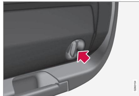
1. Solte o painel no interior da tampa do porta-bagagens rodando os dois manípulos um quarto de volta no sentido contrário ao dos ponteiros do relógio e depois desengatando o painel. Posso o painel ao lado.
