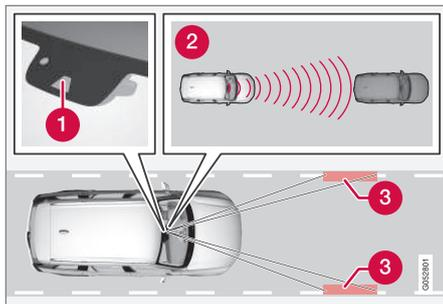
A unidade de câmara e de radar mede a distância ao veículo da frente e deteta marcações laterais.
