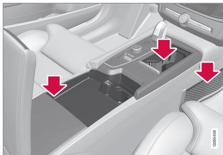
Compartimentos para arrumação com porta-canecas, tomada elétrica, bolsa de rede\* e entrada USB na consola de túnel.
