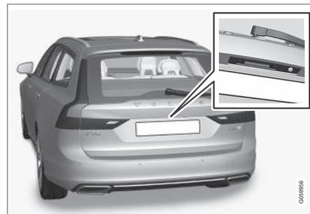
A tampa do porta-bagagens mantém-se fechada através de uma fechadura eléctrica.
