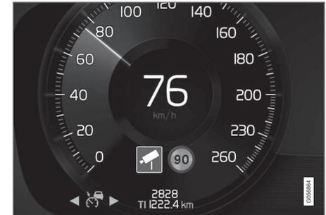
Exemplo de informação sobre câmara de velocidade e limitação de velocidade no mostrador do condutor
