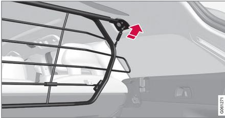
Coloque as fixações da grelha de proteção nas fixações do tejadilho.
