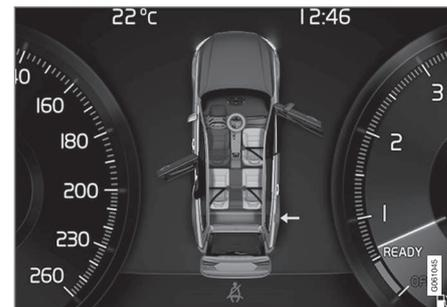
Gráfico no mostrador do condutor com diferentes tipos de avisos. A cor de aviso das portas e da tampa do porta-bagagens depende da velocidade do automóvel.
