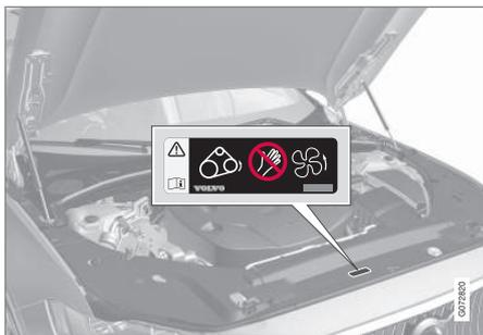
Localização do autocolante de aviso do compartimento do motor. O aspeto do compartimento do motor pode variar consoante o modelo e a variante de motor.
