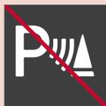
Tenha extremo cuidado ao conduzir para trás quando este símbolo aparece com um atrelado, um suporte de bicicletas ou semelhantes conectado e eletricamente ligado ao automóvel.
