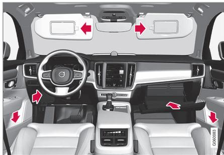
Compartimento de arrumos no painel da porta e junto ao volante, porta-luvas e proteção solar.
