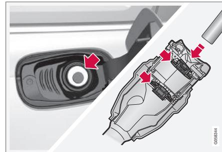
Antes de iniciar o abastecimento é importante colocar o bico da bomba para além das duas tampas com abertura do tubo de enchimento.
