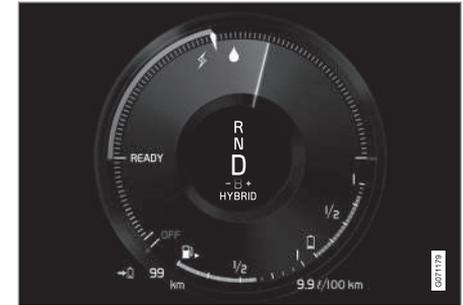
Mostrador do condutor em condução tanto com o motor eléctrico como com o motor de combustão.
