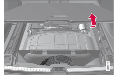
O cabo de carga encontra-se no compartimento de arrumos sob a tampa do chão do compartimento da carga.
