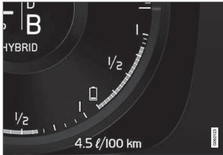
A energia da bateria híbrida é utilizada pelo motor elétrico, mas também para arrefecer ou aquecer o automóvel. O computador de bordo determina uma distância aproximada para a quantidade de energia presente na bateria híbrida.
