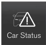
As mensagens exibidas no mostrador do condutor e que necessitam de ser guardadas são adicionadas na aplicação **Estado Carro** no mostrador central. Em simultâneo é exibida a mensagem **Msg auto guardada aplicação Estado autom.** no mostrador central.
