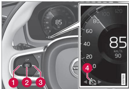
O Limitador de velocidade pode ser ativado após o arranque do motor. A velocidade mínima para memorização é 30 km/h (20 mph).
