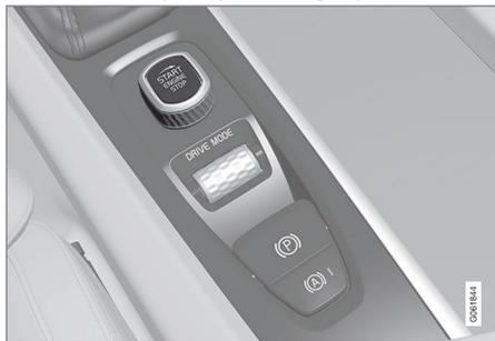
Disco de arranque na consola de túnel.
