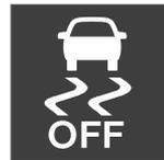
O **Modo Desport ESC** ativado é indicado no mostrador do condutor através deste símbolo aceso com luz fixa, até que a função seja desativada ou até que o motor seja desligado – no arranque do
