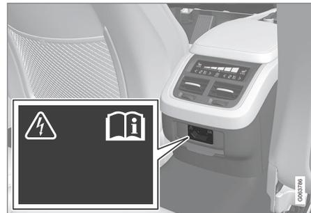
Tomada eléctrica na consola de túnel, banco traseiro.
