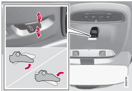
Posição de ventilação, vertical na margem traseira.
