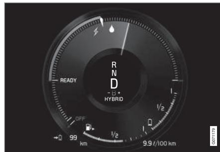
O motor elétrico não pode fornecer a quantidade de energia solicitada e o motor de combustão arranca.
