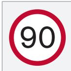
O Aviso de velocidade é efetuado através de um símbolo<sup>29</sup> do mostrador do condutor a piscar com a velocidade máxima permitida aplicável enquanto a mesma é ultrapassada.
