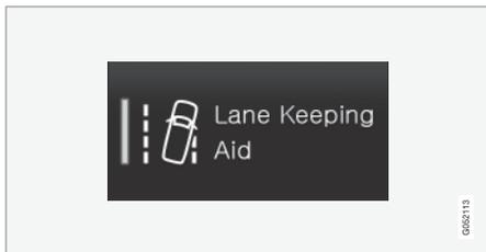
Quando um indicador LED acende a verde num botão de função e de estacionamento a função está ativada. Quando uma função é ativada aparece, para algumas funções, um texto adicional com as implicações da função. O texto é exibido durante alguns segundos, de seguida o botão é apresentado com um indicador LED aceso.
