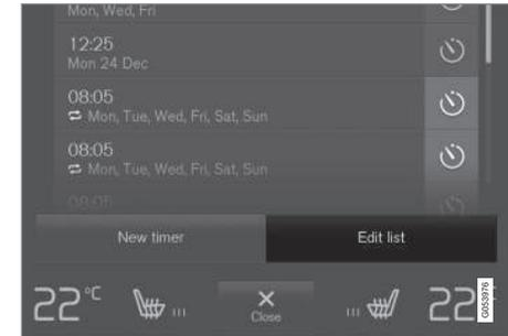
Botão para editar lista/remover definição de hora no separador **Climatização de estacionamento** na vista de climatização.
