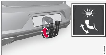
Tranque o engate de reboque inserindo-o de volta para a sua posição retraída onde fica bloqueado.
