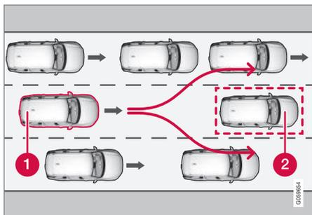
O seu automóvel (1) não "vê" qualquer hipótese de evitar o veículo à frente (2) e trava automaticamente mais cedo.
