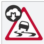
Perante alarme de piso escorregadio, aparece este símbolo no mostrador do condutor quando um veículo se aproxima do segmento de estrada escorregadio, tanto no próprio automóvel como nos outros veículos que recebem informação através do Connected Safety.
