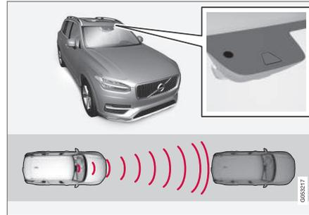
A unidade de câmara e de radar mede a distância ao veículo da frente.
