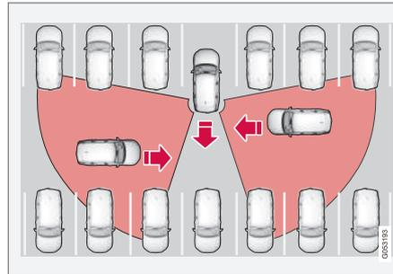
Exemplo de áreas onde o CTA pode ajudar o condutor a detetar obstáculos ao recuar.
