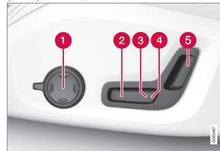
A imagem mostra o comando de um automóvel com apoio lombar de quatro vias\*. Automóveis com apoio lombar de duas vias\* não têm comando multifunções giratório.
