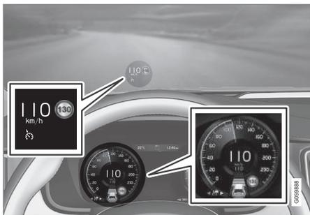
A imagem anterior mostra que o controlo da velocidade adaptativo está definido para manter 110 km/h (68 mph) e que não existe qualquer veículo à frente para seguir.
