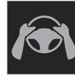
Se o Pilot Assist detetar que o condutor não mantém as mãos no volante, o sistema avisa com o símbolo e a mensagem de texto no mostrador do condutor para alertar o condutor para atuar a direção
