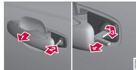
**1** Puxe para fora o puxador da porta do lado esquerdo<sup>9</sup> até a sua posição final, de modo a que o cilindro da fechadura fique visível.
