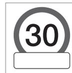
Um símbolo de sinal adicional, na forma de quadro vazio sob o símbolo de velocidade<sup>26</sup> no mostrador do condutor, significa que a função detetou uma placa adicional com informação complementar sobre a limitação de velocidade presente.
