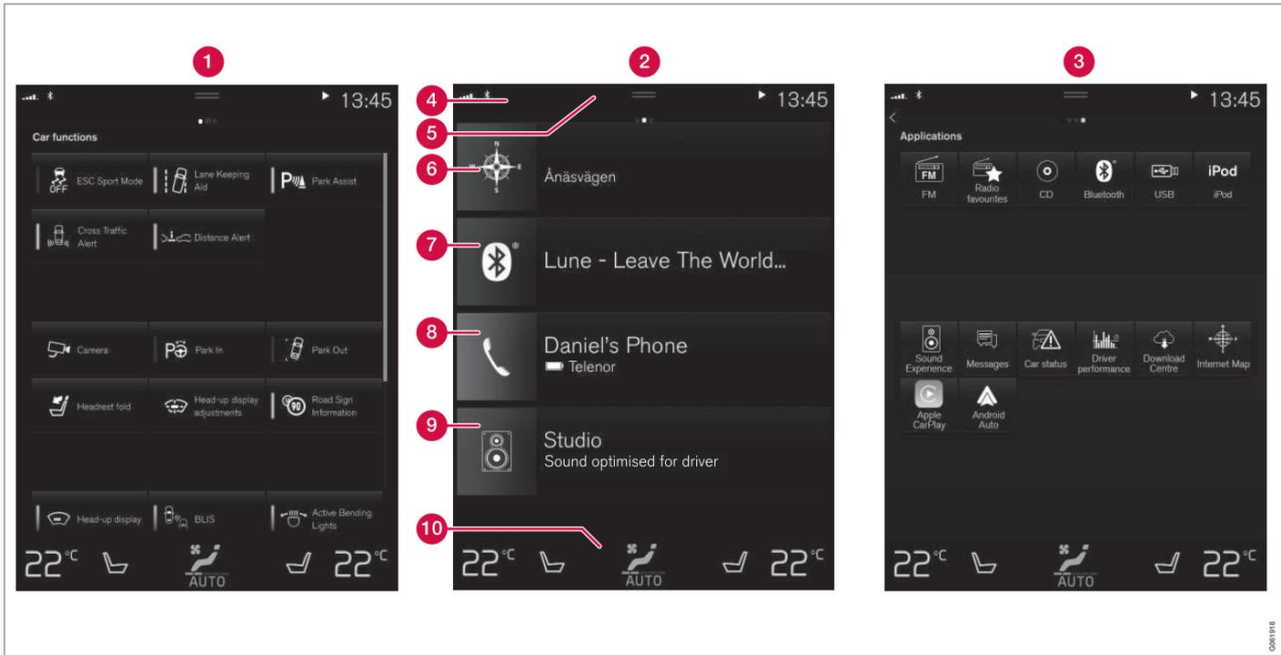
Três das vistas base do mostrador central. Faça uma passagem para a direita ou para a esquerda para aceder à vista de funções ou à vista de aplicações<sup>5</sup>.
