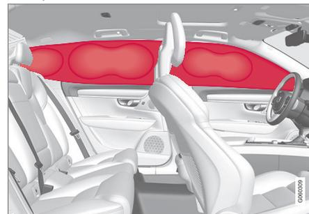
As cortinas de colisão estão montadas ao longo do forro do tejadilho, em ambos os lados, e ajudam a proteger o condutor e os passageiros nos lugares laterais do automóvel. Os painéis estão assinalados com **IC AIRBAG**.
