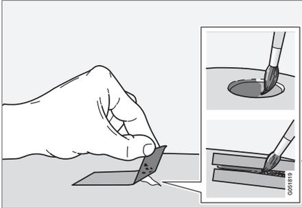
Se o dano não chegar ao metal a pintura de retoque pode ser aplicada diretamente após a limpeza da superfície.
