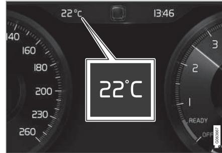
O indicador de temperatura exterior pode mostrar um valor de temperatura demasiado alto após o automóvel ter estado parado.
