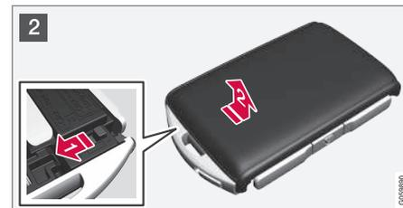
2 **1** Vire a chave, desloque o botão para o lado e levante a parte de trás da tampa alguns milímetros para cima.
