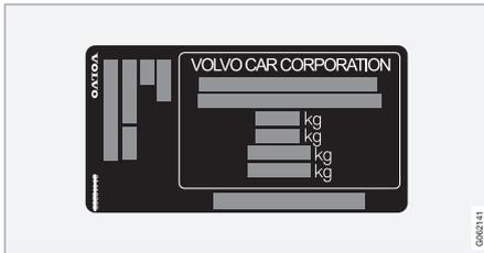
1 autocolante da designação do tipo, modelo, número de chassis, pesos máximos permitidos, código para a cor exterior e número da homologação do tipo. O autocolante encontra-se no pilar da porta e fica visível quando a porta direita traseira é aberta.
