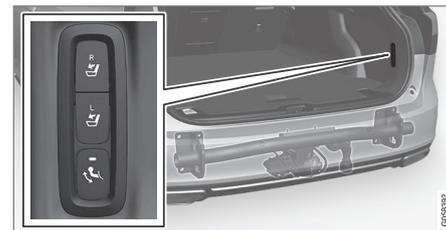
Abra a tampa do porta-bagagens. Na parte de trás do painel lateral direito do compartimento da carga existe um botão para retração e rebatimento do engate de reboque. Para que a função de rebatimento esteja ativa é necessário que esteja acesa uma luz indicadora cor de laranja no botão.
