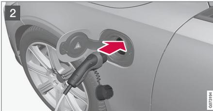
2 Abra a tampa de carga. Solte a tampa de proteção da pega de carga e pressione a pega de carga até ao fundo na tomada do automóvel.
