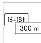
Algumas velocidades são válidas após, por exemplo, um determinado trajeto ou durante determinadas horas do dia. O condutor é alertado para estas condições com um símbolo de sinal adicional
