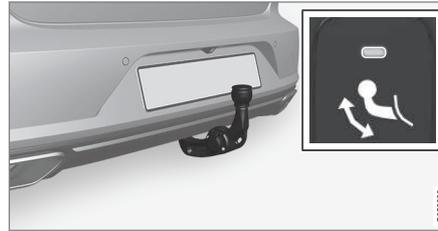
Desloque o engate de reboque para a sua posição final onde este fixa e bloqueia - a luz indicadora assume luz fixa cor-de-laranja.
