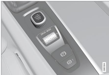
Disco de arranque na consola de túnel.
