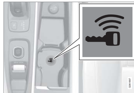
トンネルコンソール内のバックアップリーダーの場 所
