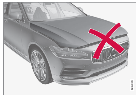
Cofano non completamente chiuso.
