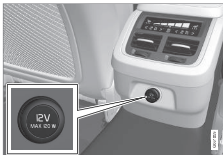
Presa elettrica da 12 V nel tunnel, sedile posteriore.
