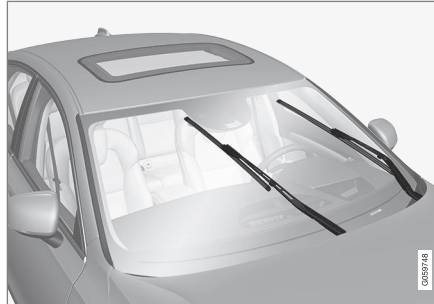
Balais d'essuie-glace en position d'entretien.
