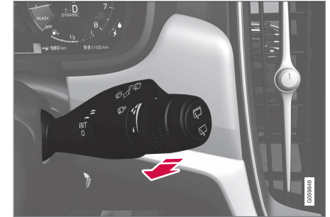
Fonction lave-glace, levier droit au volant
