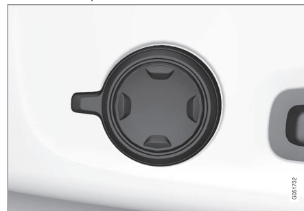
Monitoimisäädin, sijoitettu istuimen istumaosan sivulle.
