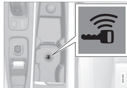
Backup-læserens placering i tunnelkonsollen.
