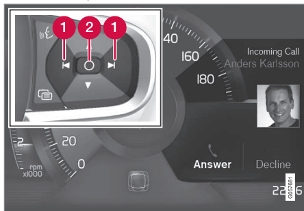
Приклади повідомлень на дисплеї водія 4 та правій кнопковій панелі керма.
