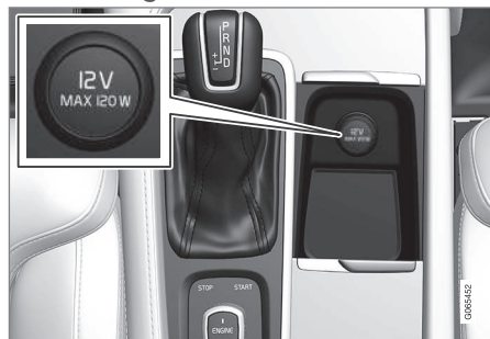
12 V-eluttag i tunnelkonsol, framsäte.
