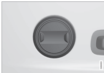
Reglaget i bilar med tvåvägssvankstöd*.
