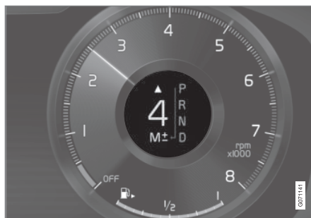
Växlingsindikator i 12-tums förardisplay för stor växelspak*.
