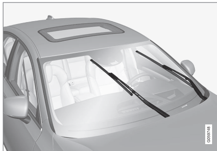
Torkarblad i serviceläge.
