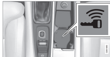
Locația cititorului de rezervă din consola tunel.
