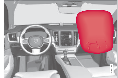
Czołowa poduszka powietrzna pasażera przedniego fotela.
