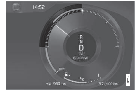
Wskaźnik ECO na 12-calowym wyświetlaczu kierowcy*.
