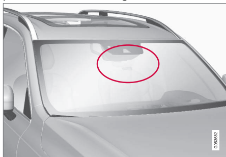
Umieszczenie modułu kamery
