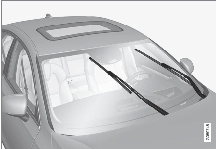
Pióra wycieraczek w pozycji serwisowej.
