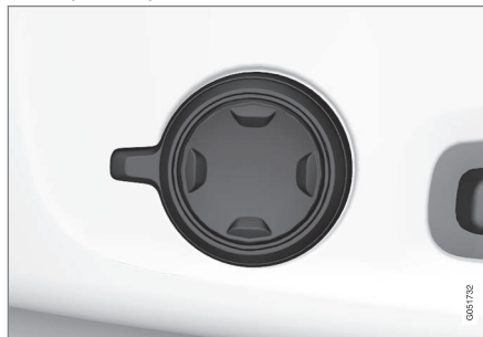
Multifunksjonsbryteren, i biler med 4-veis korsryggstøtte*.
