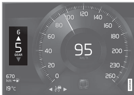
Girindikator på 8-tommers førerdisplay.
