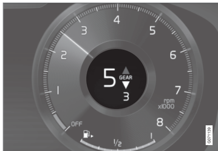
Girindikator på 12-tommers førerdisplay*.
