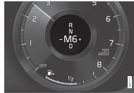
Girskiftindikator for liten girspak på 12-tommers førerdisplay*.
