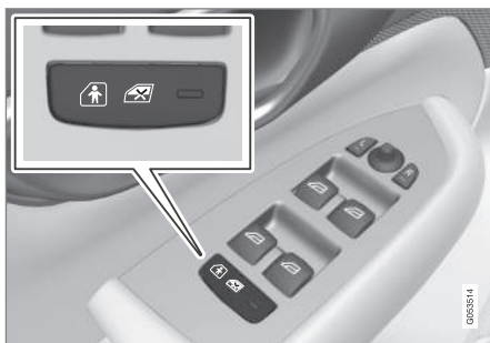
Knapp for elektrisk aktivering og deaktivering.
