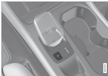
Oversikt over girspaken og stillingen P for den lille girspaken.
