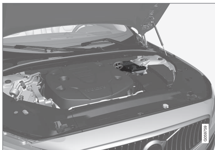
12 V-hjelpebatteriet er plassert i en boks ved siden av fjærbentoppen.
