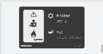
2 Külmutusainet R1234yf kasutava kliimasüsteemiga auto kleebis.
