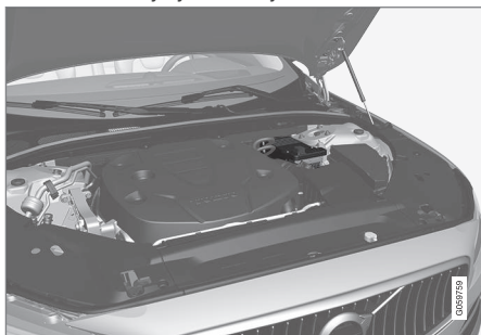
12 V varuaku asub amordipüstaku kõrval olevas kastis.
