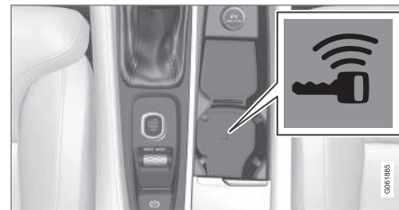
Ubicación del lector de seguridad en la consola del túnel.
