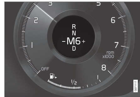
Gearskifteindikator på 12-tommers førerdisplay for lille gearstang*.
