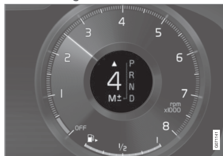
Gearskifteindikator på 12-tommers førerdisplay for stor gearstang*.
