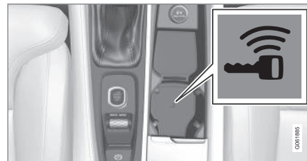
Umístění záložní čtečky v tunelové konzole.
