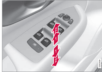
Керування вікнами з електропідійомниками.
