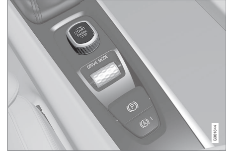
Tünel konsolundaki çalıştırma düğmesi.
