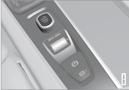
Tünel konsolundaki çalışma düğmesi.
