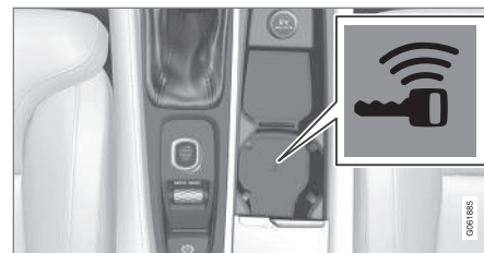
Backup-läsarens placering i tunnelkonsolen.
