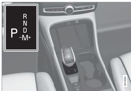
小型セレクトーレバーおよびドライバーディスプレイのシフトパターンの概観
