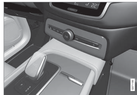
ギヤセレクトターインヒビターを非作動状態にすることができない小型セレクトターレバーの概観
