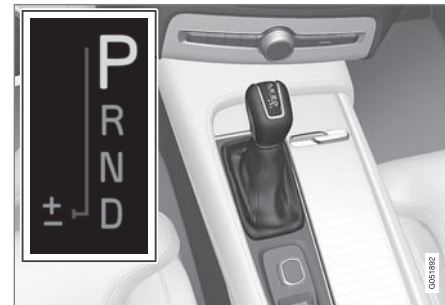
大型セレクトレーバーとドライバーディスプレイのシフトパターンの概観
