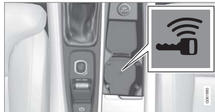
トンネルコンソール内のバックアップリーダの場所
