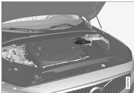
La batteria ausiliaria da 12 V si trova in un vano accanto al duomo dell'ammortizzatore.
