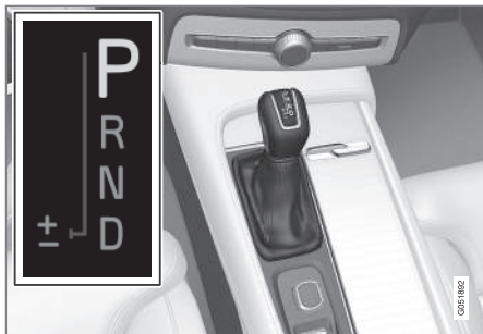
Visión general de palanca de cambios grande y patrón de cambios en la pantalla del conductor.
