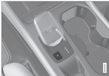
Vista general de la palanca de cambios y la posición P de la palanca de cambios pequeña.
