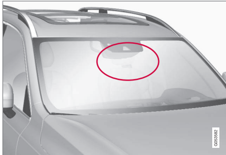
Θέση της μονάδας ραντάρ
