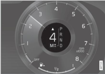
Schaltanzeige auf dem 12-Zoll-Fahrerdisplay bei großem Wählhebel\*.
