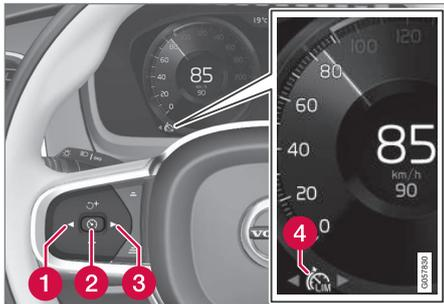
Die Geschwindigkeitsbegrenzung kann erst nach dem Start des Motors aktiviert werden. Als niedrigste Höchstgeschwindigkeit kann 30 km/h (20 mph) gespeichert werden.
