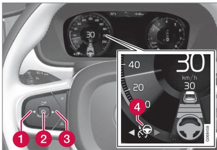
Das grüne Lenkrad zeigt an, dass eine Lenkunterstützung durch Pilot Assist erfolgt.
