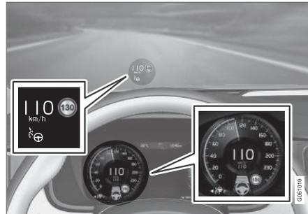
In der obigen Abbildung ist die Funktion Pilot Assist auf 110 km/h (68 mph) eingestellt, und das Fahrzeug kann keinem vorausfahrenden Fahrzeug folgen.
