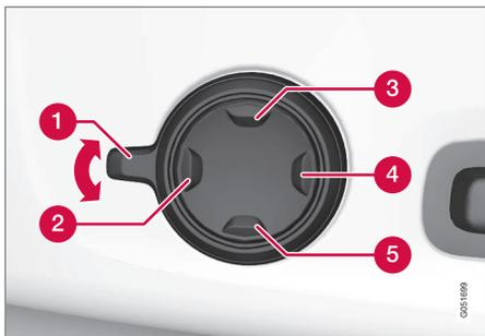
1. Den Multifunktionsschalter durch Drehen des Bedienelements **1** nach oben/unten aktivieren. Auf dem Center Display erscheint die Ansicht zur Sitzverstellung.
