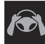
Wenn Pilot Assist erkennt, dass sich die Hände nicht am Lenkrad befinden, fordert die Funktion Sie mit einem Symbol und einer Meldung im Fahrerdisplay auf, das Fahrzeug wieder aktiv zu lenken.
