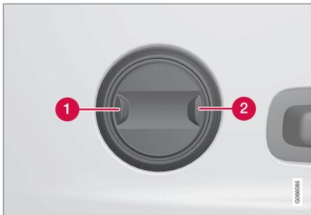
1. Drücken Sie den vorderen Teil **1** des runden Schalters, um die Lendenwirbelstütze zu erhöhen.
