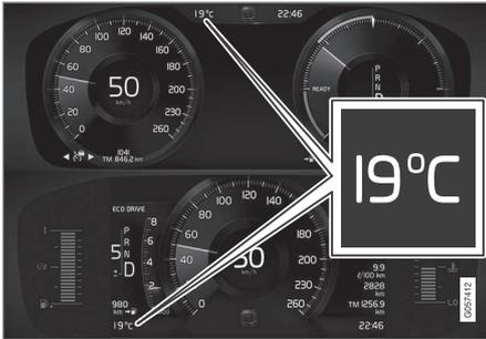
Lage des Außentemperaturmessers auf dem 12-\* bzw. 8-Zoll-Fahrerdisplay. Die Abbildung ist thematisch - je nach Fahrzeugmodell können die Einzelheiten unterschiedlich sein.
