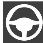
Bei reduzierter Leistung erscheinen auf dem Fahrerdisplay dieses Symbol und die Meldung **Servolenkung Assistent zeitweilig eingeschränkt!**
