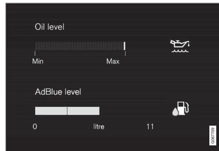
Darstellung für den AdBlue-Füllstand im Center Display.
