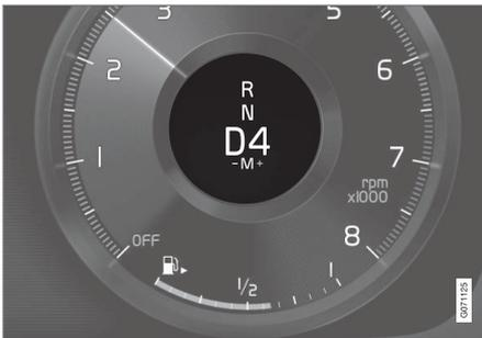
Fahrerdisplay beim Schalten mit den Schaltwippen (kleiner Wählhebel).
