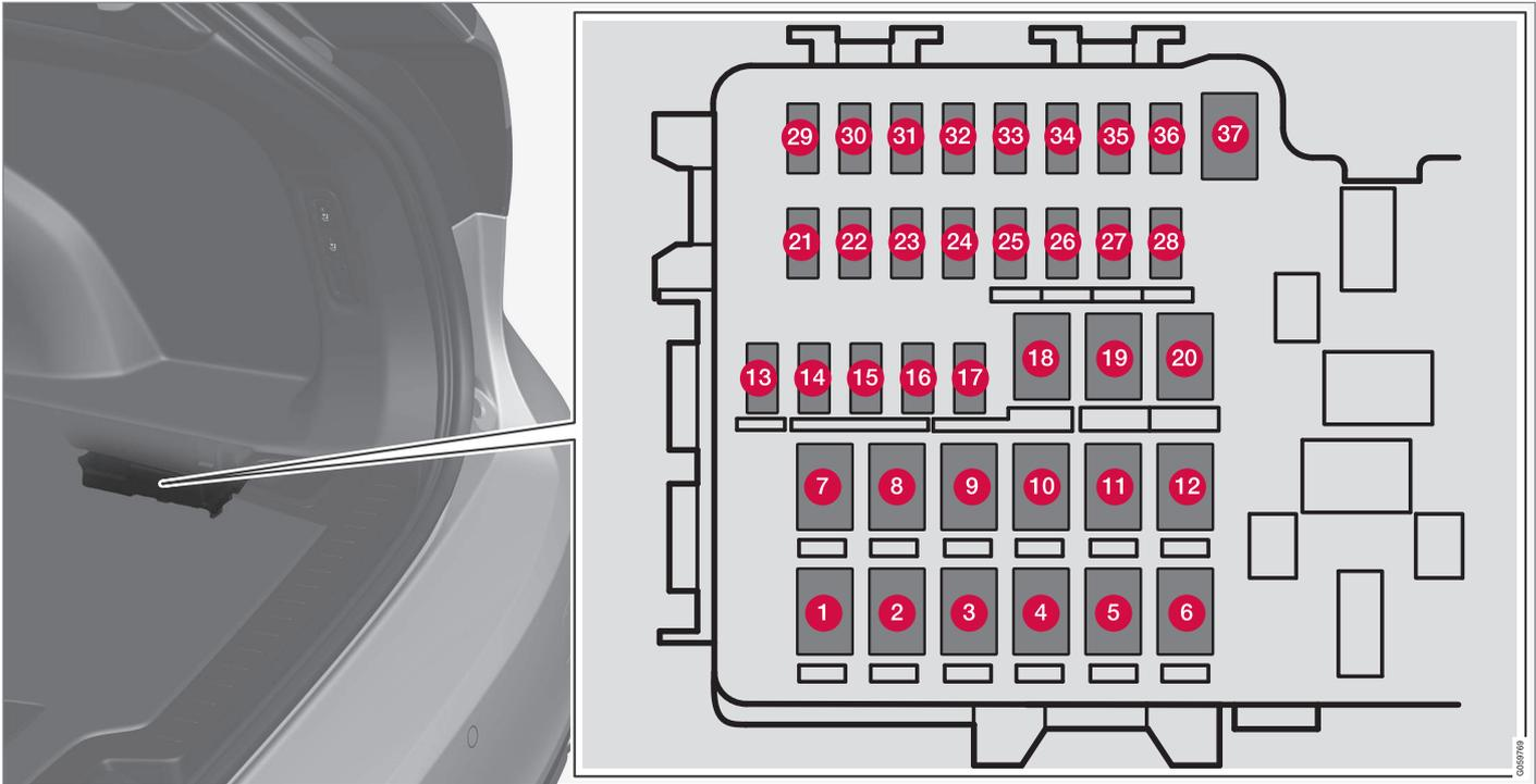
Der Sicherungskasten befindet auf der rechten Seite.
