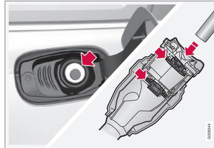
Es ist wichtig, das Trichterrohr der Zapfpistole an den beiden zu öffnenden Klappen des Einfüllrohrs passieren zu lassen, bevor man mit dem Tanken beginnt.
