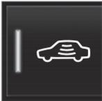
Tippen Sie in der Ansicht Funktionen des Center Displays auf **Verminderter Schutz**, um die Bewegungs- und Neigungssensoren beim nächsten Verriegeln des Fahrzeugs zu deaktivieren.
