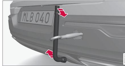
Öse ordentlich festziehen, dafür als Hebel zum Beispiel den Radmutternschlüssel\* verwenden.
