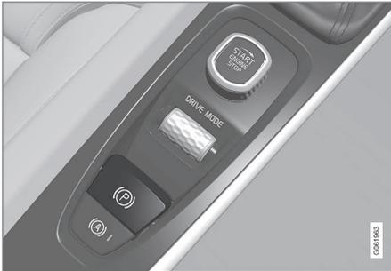
Der Hebel der Feststellbremse befindet sich auf der Tunnelkonsole zwischen den beiden Vordersitzen.
