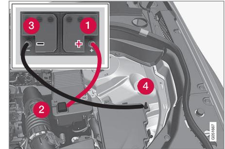
Anschlusspunkte der Starthilfekabel. Das Aussehen im Motorraum kann je nach Modell und Ausstattung variieren.
