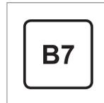
B7 steht für **Dieseldieselkraftstoff**, der bis zu 7 Vol.-% Biodiesel oder Fettsäuremethylester (FAME) enthält.
