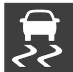
Wenn die Anhänger-Stabilisierungskontrolle eingreift, blinkt auf dem Fahrerdisplay das ESC-Symbol.
