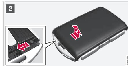
**2** **1** Drehen Sie den Schlüssel um, führen Sie den Schalter zur Seite und schieben Sie die Abdeckung der Rückseite einige Millimeter nach oben.
