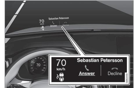
Auf dem Head-up-Display werden Warnungen und Informationen zu Geschwindigkeit, Tempomatfunktionen, Navigation usw. direkt in das Sichtfeld des Fahrers eingeblendet. Auch Verkehrsschildinformationen und eingehende Anrufe können auf dem Head-up-Display angezeigt werden.
