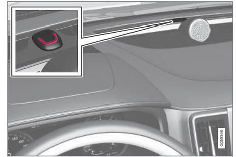
Wenn das Fahrzeug verriegelt und die Alarmanlage aktiviert ist, blinkt eine rote LED am Armaturenbrett alle zwei Sekunden auf.
