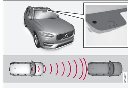
Die Kamera- und Radarsensoren messen den Abstand zum vorausfahrenden Fahrzeug.
