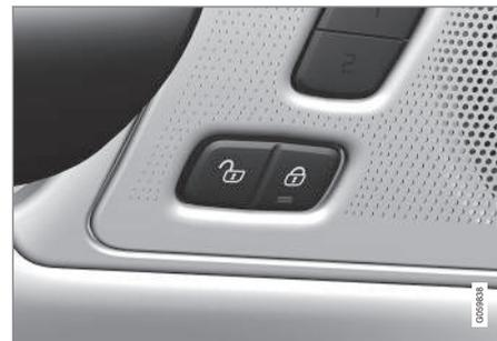
Verriegelungstasten mit Anzeigeleuchte an der Vordertür.
