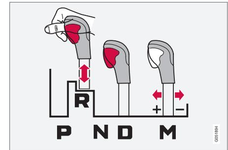
Wählhebelsperre für Fahrzeuge mit großem Wählhebel.
