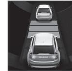
Nur wenn das Abstandssymbol zwei Fahrzeuge zeigt, regelt die adaptive Geschwindigkeitsregelung den Zeitabstand zum vorausfahrenden Fahrzeug. Gleichzeitig wird ein Geschwindigkeitsbereich markiert.
