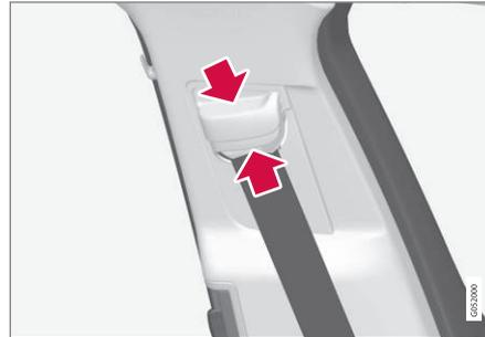
Drücken Sie die Gurthalterung zusammen und verschieben Sie den Gurt nach oben oder unten.
