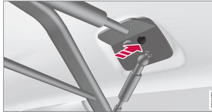
Die mitgelieferte Schraube einsetzen und mit dem mitgelieferten 6-mm-Inbus-schlüssel anziehen. Auf der anderen Seite ebenso vorgehen. Empfohlenes Anzugs-moment: 20 Nm (15 ft-lb).
