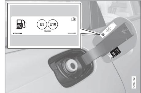
Kraftstoff tanken, der gemäß der Kennzeichnung<sup>24</sup> auf der Innenseite der Tankklappe für das Fahrzeug zugelassen ist. Zu zugelassenen Kraftstoffen und ihrer Kennzeichnung siehe die Abschnitte „Benzin“ bzw. „Diesel“.
