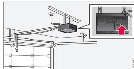
4. Finden Sie die Anlerntaste<sup>41</sup> am Empfänger, z. B. Garagentor. Die Platzierung ist normalerweise in der Nähe der Antennenfassung am Empfänger.
