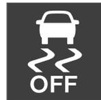
Der aktivierte **ESC Sport-Modus** wird im Fahrerdisplay angezeigt, indem dieses Symbol permanent leuchtet, bis die Funktion deaktiviert oder der Motor abgestellt wird – nach dem nächsten
