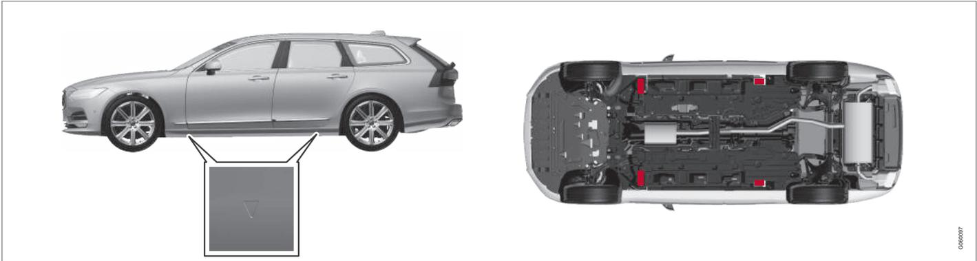
Die Dreiecke an der Kunststoffverkleidung zeigen, wo sich die Wagenheber-Befestigungspunkte/Aufnahmepunkte (rot markiert) befinden.
