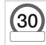
Ein Symbol für ein Zusatzschild in Form eines leeren Rahmens unter dem Geschwindigkeitssymbol<sup>26</sup> im Fahrerdisplay bedeutet, dass die Funktion ein Zusatzschild mit zusätzlichen Informationen zur aktuellen Geschwindigkeitsbegrenzung erkannt hat.
