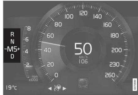
Schaltanzeige auf dem 8-Zoll-Fahrerdisplay bei kleinem Wählhebel.
