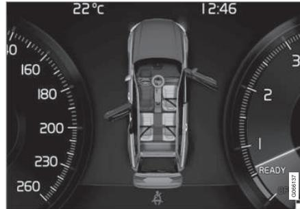
Grafik im Fahrerdisplay mit verschiedenen Arten von Warnungen. Die Warnfarbe an Türen und Heckklappe ist von der Geschwindigkeit des Fahrzeugs abhängig.
