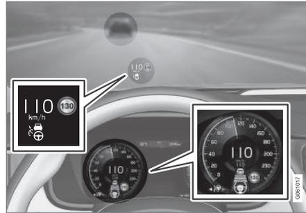
In der obigen Abbildung ist die Funktion Pilot Assist auf 110 km/h (68 mph) eingestellt, und das Fahrzeug folgt einem vorausfahrenden Fahrzeug mit der gleichen Geschwindigkeit.
