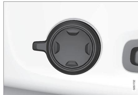
Multifunktionsschalter, in Fahrzeugen mit Vier-Wege-Lendenwirbelstütze\*.
