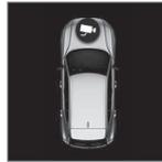
Welche der Kameras aktiv ist, wird durch eine Kamera auf dem Fahrzeugsymbol auf dem Center Display angezeigt.
