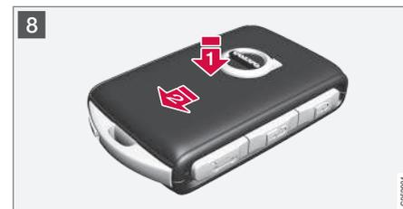
**8** **1** Transponderschlüssel umdrehen und die Abdeckung der Vorderseite wieder anbringen, indem sie nach unten gedrückt wird, bis ein Klickgeräusch zu hören ist.
