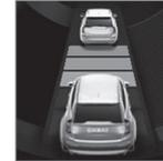
Es können verschiedene Zeitabstände zum vorausfahrenden Fahrzeug eingestellt und auf dem Fahrerdisplay als 1-5 horizontale Linien angezeigt werden – je mehr Linien, desto größer der Zeitabstand.
