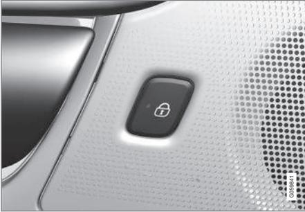
Verriegelungstaste mit Anzeigelampe an der Fondtür.
