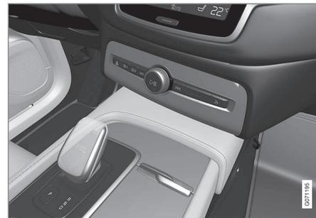
Übersicht zum kleinen Wählhebel, bei dem es nicht möglich ist, die Wählhebelsperre zu deaktivieren.
