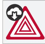
Wenn sich das eigene Fahrzeug einem Fahrzeug nähert, an dem die Warnblinkanlage eingeschaltet ist, wird auf dem Fahrerdisplay dieses Symbol angezeigt.
