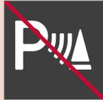
Wenn ein Anhänger, ein Fahrradträger o. Ä. an das Fahrzeug angekoppelt und an die Fahrzeugelektrik angeschlossen ist und dieses Symbol angezeigt wird, ist beim Zurücksetzen besondere Vorsicht geboten.
