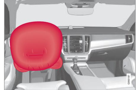
Lenkrad-Airbag und Knie-Airbag<sup>1</sup> am Fahrersitz.
