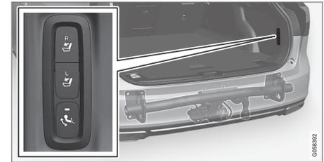
Öffnen Sie die Heckklappe. An der rechten Kofferraumwand befindet sich ein Schalter zum Ein- und Ausklappen der Anhängerkupplung. Damit die Anhängerkupplung ausgeklappt werden kann, muss die Anzeileuchte des Schalters orange leuchten.
