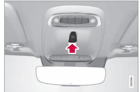
Das Panoramadach und die Sonnenblende werden mit einem Schalter an der Decke bedient.
