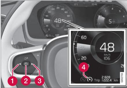
Damit der Tempomat aus dem Bereitschaftsmodus eingeschaltet werden kann, muss die aktuelle Fahrzeuggeschwindigkeit mindestens 30 km/h (20 mph) betragen.
