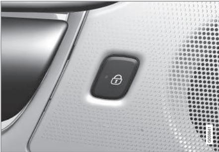
Verriegelungstaste mit Anzeigeleuchte an der Fondtür.
