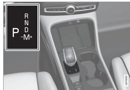
Kleiner Wählhebel und Schaltmuster auf dem Fahrerdisplay.
