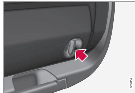
1. Die Innenverkleidung der Heckklappe lösen, indem zunächst die beiden Drehgriffe um eine Vierteldrehung gegen den Uhrzeigersinn gedreht werden und dann die Verkleidung ausgehakt wird. Die Abdeckung zur Seite legen.
