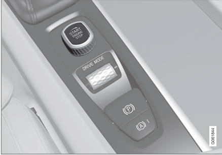
Tünel konsolundaki çalıştırma düğmesi.
