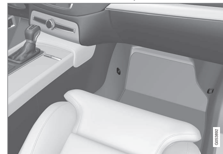
Расположение точек крепления для переднего сиденья.
