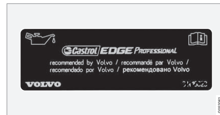
6 Наклейка с указанием масла для двигателя.
