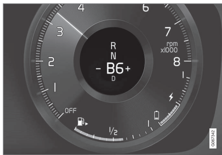
Panorâmica geral da posição de travão no mostrador do condutor.
