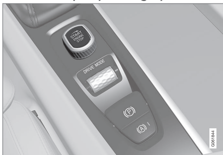
Disco de arranque na consola de túnel.
