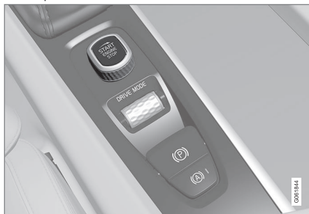
Disco de arranque na consola de túnel.
