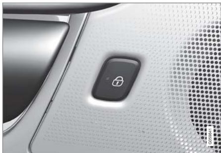
リアドアのインジケータランプ付きロックボタン
