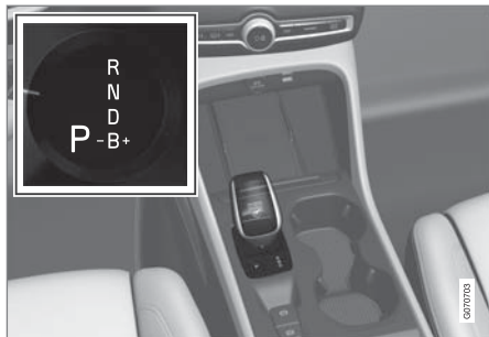
セレクターレバーおよびドライバーディスプレイのシフトパターンの概観
