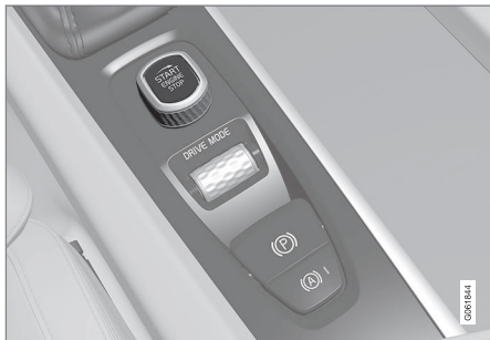
Interruttore di avviamento nel tunnel.
