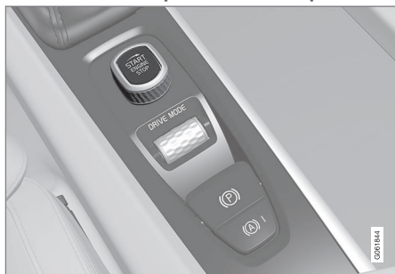
Interruttore di avviamento nel tunnel.
