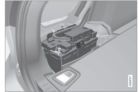
Az indítóakkumulátor a csomagtérben helyezkedik el.
