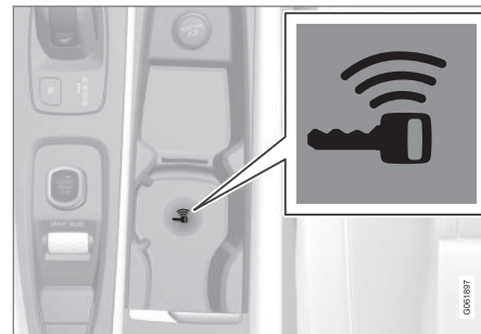
Tagavaralugur asub kesktunneli konsoolis.
