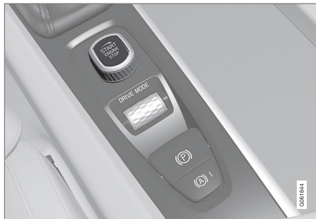
Tunnelkonsoolil paiknev käivitusnupp.
