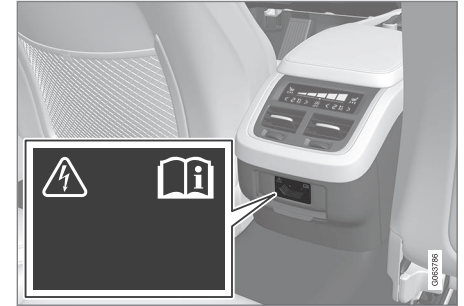
Steckdose in der Tunnelkonsole, Fond.
