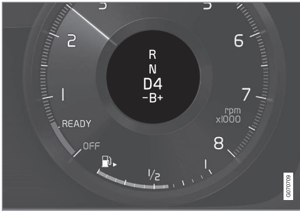
Fahrerdisplay beim Schalten mit den Schaltwippen.
