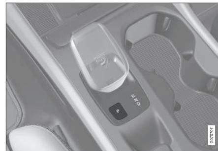
Übersicht über Wählhebel und Stellung P.
