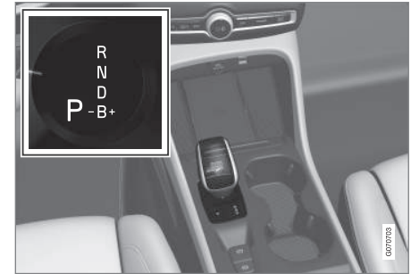
Wählhebel und Schaltmuster auf dem Fahrerdisplay.
