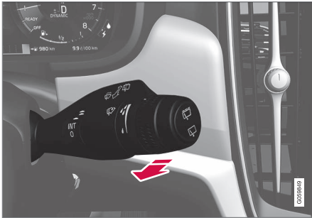
Waschfunktion, rechter Lenkradhebel.
