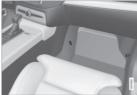
Lage der Befestigungspunkte für den Vordersitz
