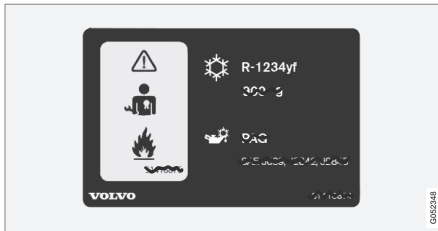
2 Aufkleber für Klimaanlage mit Kältemittel R1234yf.
