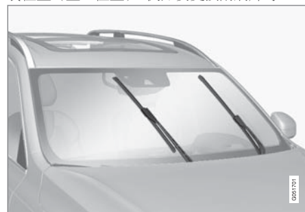
位於維修位置的雨刷片。
