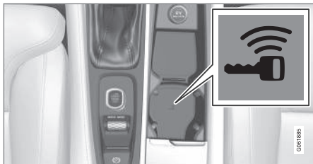
Backup-läsarens placering i tunnelkonsolen.
