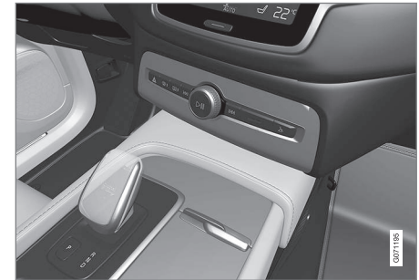
Компактный рычаг переключения передач без отключения блокиратора переключения передач.
