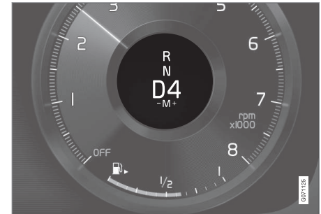
Дисплей водителя при переключении передач с помощью лепестков для компактного рычага переключения передач.
