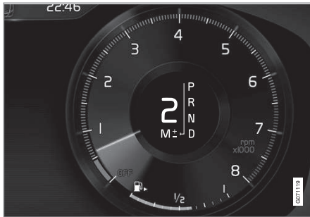
Дисплей водителя при переключении передач в ручном режиме с помощью лепестков; высокий рычаг переключения передач.
