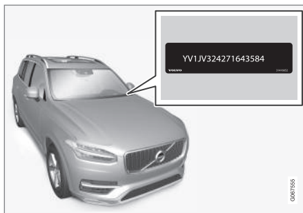
На всех моделях номер VIN расположен в одном и том же месте.
