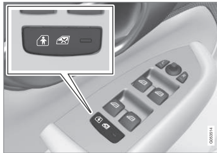
Кнопка для активирования и отключения электрической блокировки.
