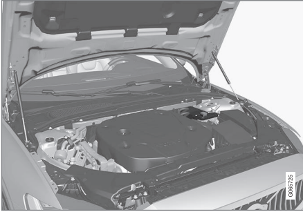
A bateria de apoio 12 V encontra-se no compartimento do motor.
