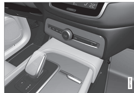
Panorâmica geral da alavanca das mudanças pequena em que não é possível desativar o inibidor do selector de mudanças.
