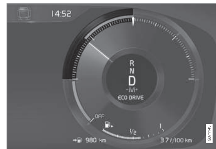
Medidor ECO no mostrador do condutor 12 polegadas*.
