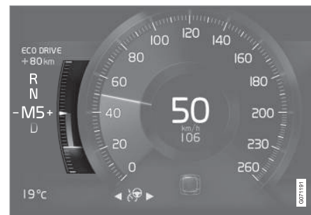
Medidor ECO no mostrador do condutor 8 polegadas.
