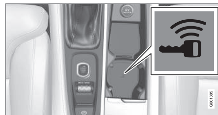
Localização do leitor no console de túnel.
