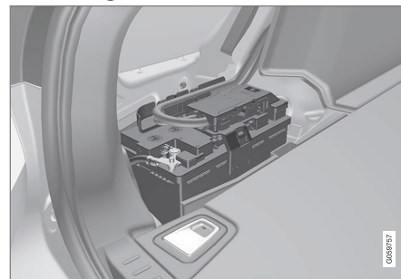
Startbatteriet sitter i bagasjerommet.
