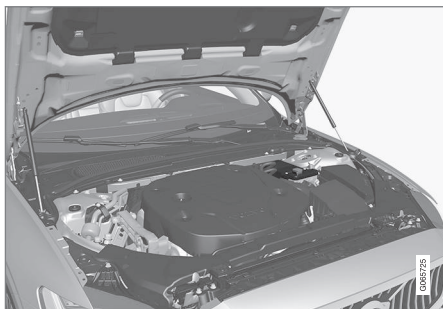
12 V-hjelpebatteriet er plassert i motorrommet.
