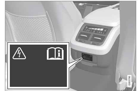
Stroomaansluiting in tunnelconsole, achterin.
