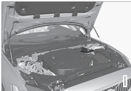
De hulpaccu van 12 V zit in de motorruimte.
