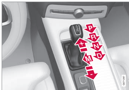
Overzicht grote schakelhendel en schakelstanden.
