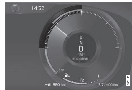
Misuratore ECO sul display del conducente da 12".
