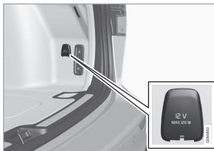
Presa elettrica da 12 V nel bagagliaio*.
