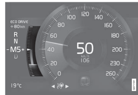
Misuratore ECO sul display del conducente da 8".
