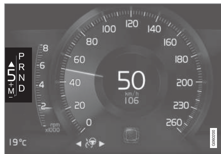
Indicatore cambio di marcia sul display del conducente da 8" per la leva selettoria grande.
