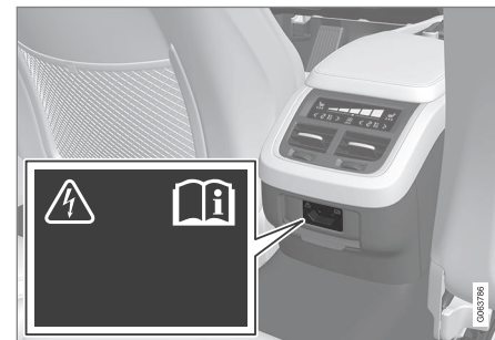
Presa elettrica nel tunnel, sedile posteriore.
