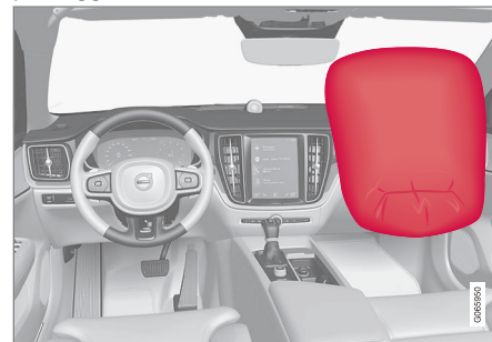
Airbag nel sedile anteriore sul lato passeggero.
