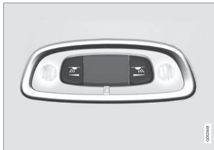
Luci di lettura sopra il sedile posteriore.
