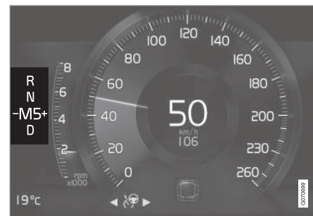
Indicatore cambio di marcia sul display del conducente da 8" per la leva selettoria piccola.
