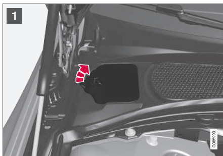
Serbatoio di espansione dell'impianto di raffreddamento
