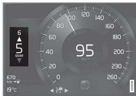
Fokozatváltás-jelző a 8-hüvelykes járművezetői kijelzőn.
