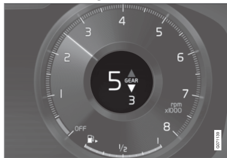
Fokozatváltás-jelző a 12-hüvelykes járművezetői kijelzőn*.
