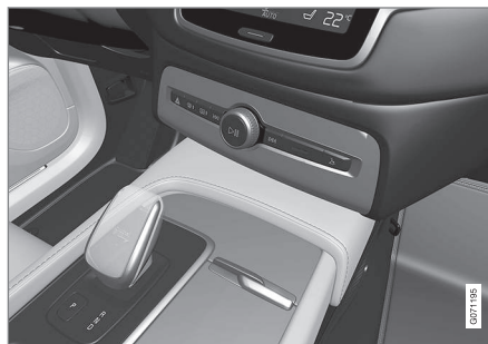
A kis sebességváltó kar áttekintése, ahol nem lehetséges a fokozatváltás-gátló inaktíválása.
