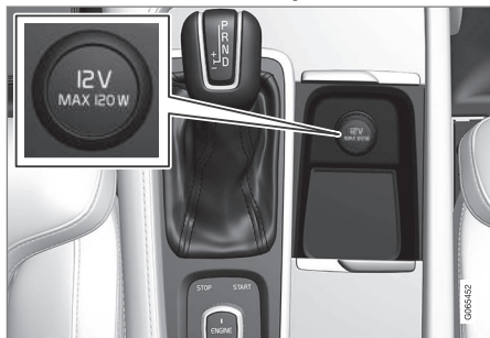
12 voltos elektromos aljzat az alagút konzolban, első ülés.
