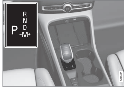
Kis sebességváltó kar és a váltási minta áttekintése a járművezetői kijelzőn.
