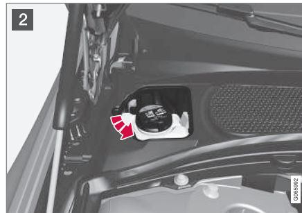
Réservoir de dilatation du liquide de refroidissement
