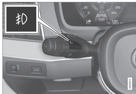
Botón para la luz antiniebla delantera.
