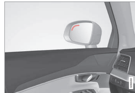
Ubicación del testigo de BLIS
