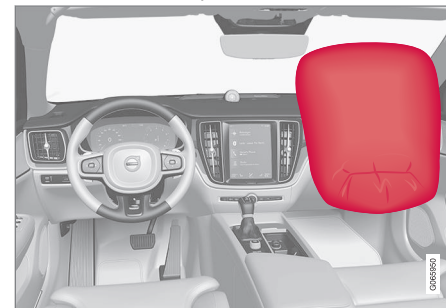
Airbag en el asiento delantero del acompañante.
