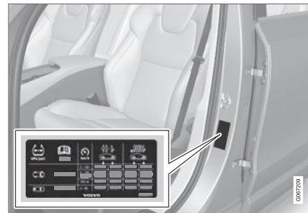
Ubicación de la etiqueta de presión de neumáticos
