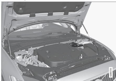
Støttebatteriet på 12 V er placeret i motorrummet.
