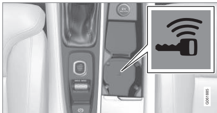
Backup-læserens placering i tunnelkonsollen.
