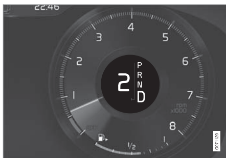
ステアリングホイールパドルでギヤをシフトしているときの、ドライバーディスプレイ（大型セレクトーレバー）
