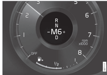
Indicatore cambio di marcia sul display del conducente da 12" per la leva selettoria piccola*.
