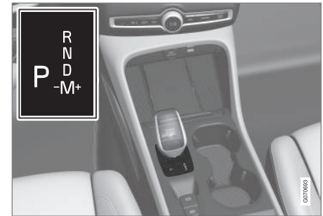
Panoramica della leva selettoria piccola e schema di cambio sul display del conducente.
