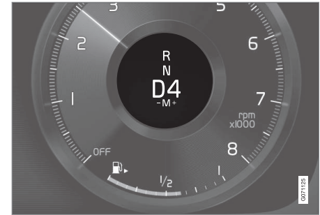
Display del conducente in caso di cambio marcia con le leve al volante e la leva selettoria piccola.
