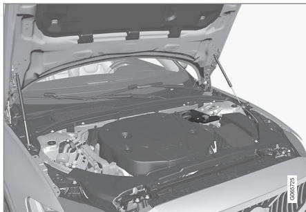
La batteria ausiliaria da 12 V si trova nel vano motore.
