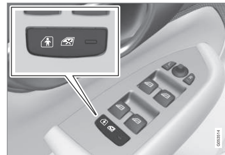
Pulsante di attivazione e disattivazione elettrica.
