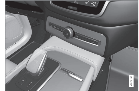
Panoramica della leva del cambio piccola dove non è possibile disattivare l'immobilizzatore della leva selettore.
