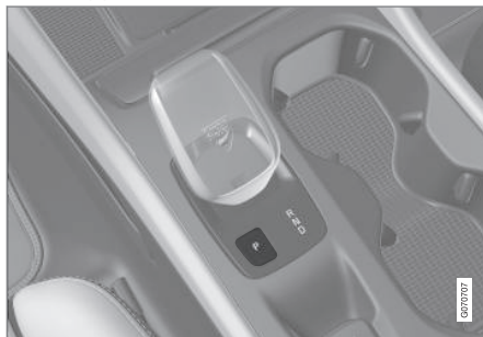
Panoramica della leva selettore e della posizione P per la leva selettore piccola.
