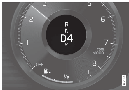
Kuljettajan näyttö vaihdettaessa ohjauspyörävalitsimilla, pieni vaihdevipu.
