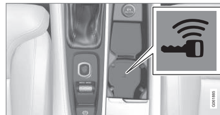
Varmistuslukijan sijainti tunnelikonsolissa.
